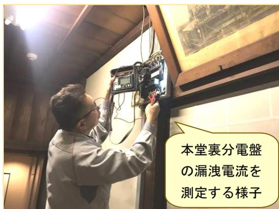
本堂裏分電盤の漏洩電流を測定する様子
